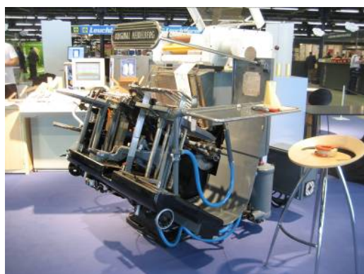
La machine qui pose la dorure sur le bloc spécial du salon, « Original Heidelberg »
